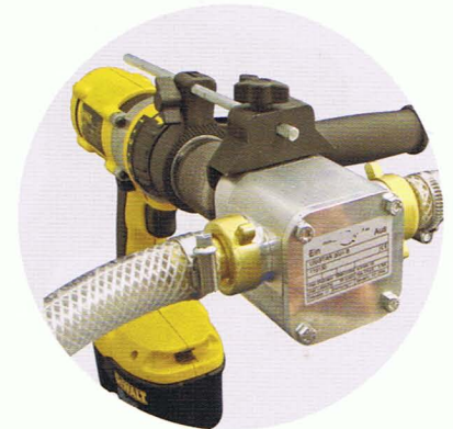
Anwendungsbeispiel mit Adapter und Akkuschrauber
